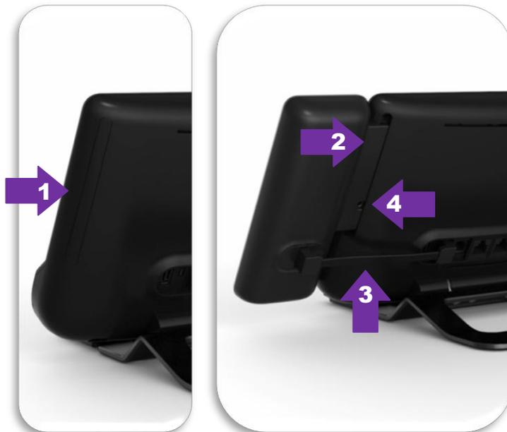
1. Spezialschutzfach an der Rückseite des Geräts abnehmen
